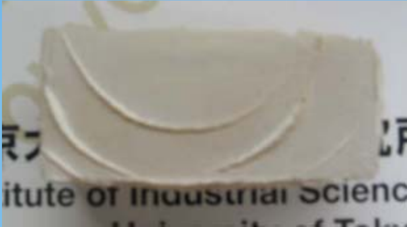
石膏をばらして取り出し 後の高密度化部品
